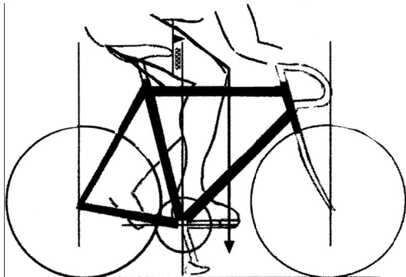
また、身体形態上の理由によりハンドルの下限および、ステアリング・システムの延長部（いわゆるDHハンドル）の先端がBBの垂線より75cm以上になる場合には、乗車姿勢および前腕と上腕の角度をチェックして許可を得てから使用して下さい。
